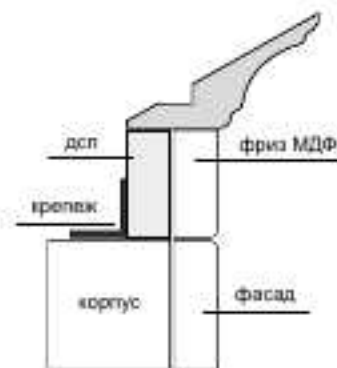
Схема крепления карнизов
